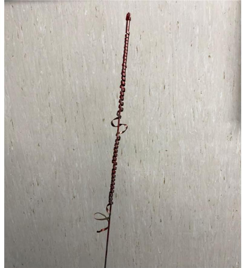
Rottura fresa endomidollare
